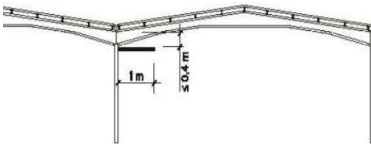
Figura 2.14: Compartimentación en cubierta por medio de barrera debajo de la cubierta.
